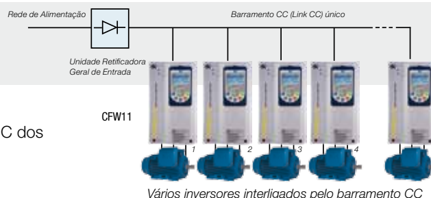
Vários inversores interligados pelo barramento CC
